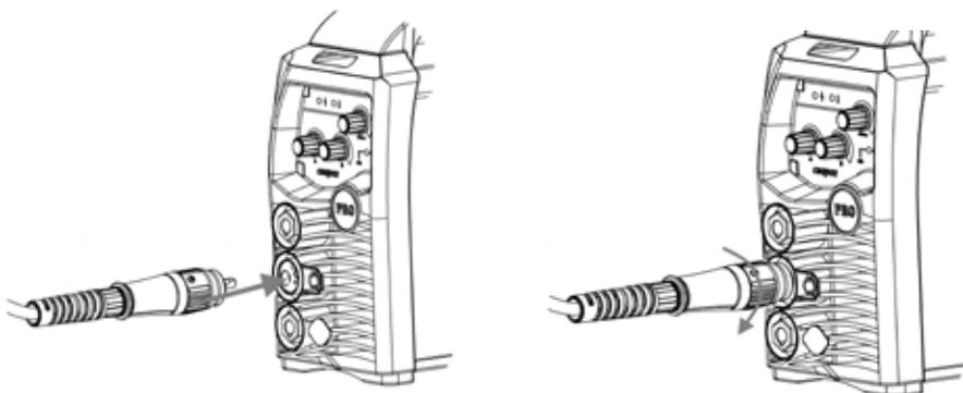
Рис. 7.1. Подключение горелки.
