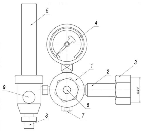
Рис. 1. Регуляторы расхода газа:
